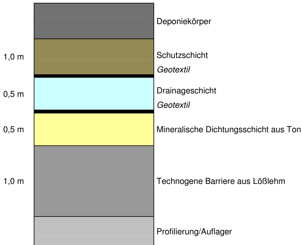
Profil 1: Aufbau des Basisabdichtungssystems für die Mineralstoffdeponie Profen-Nord
