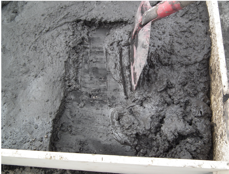
Abbildung 5-16: Wasserzugabe (20 min); aufgeschlammte lockere Schicht
