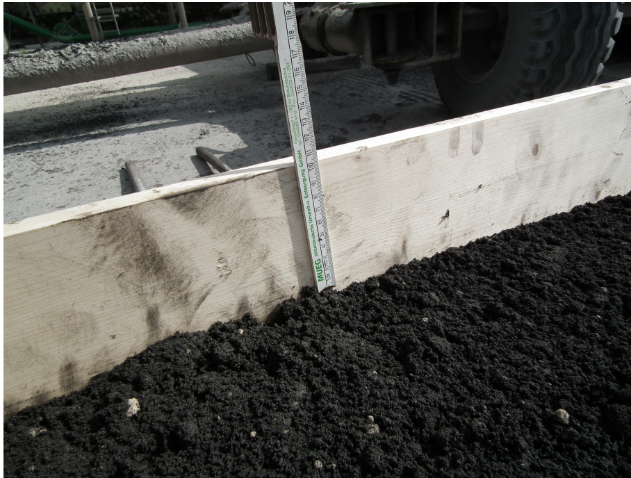
Abbildung 5-12: Lockere Schicht (Höhe 7 cm)
