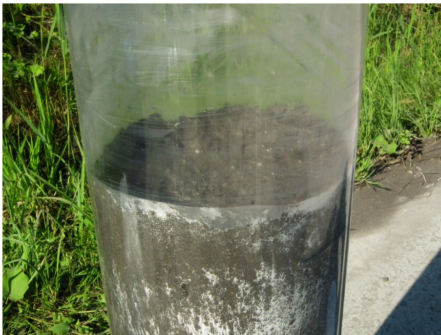
Abbildung 5-18: Gießereialsand-Braunkohlenflugasche-Gemisch 20 min abgebunden
