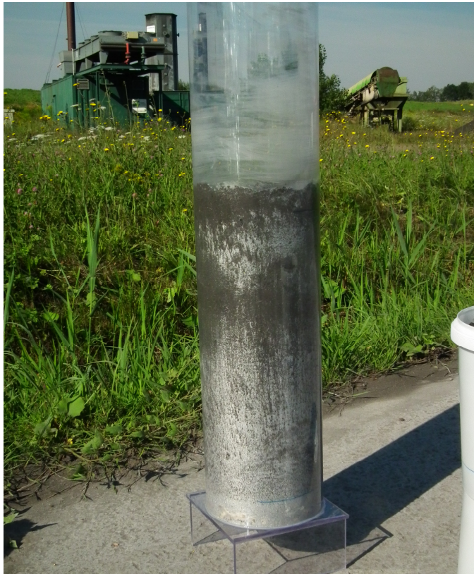
Abbildung 5-17: Gießereialsand-Braunkohlenflugasche-Gemisch frisch eingebaut
