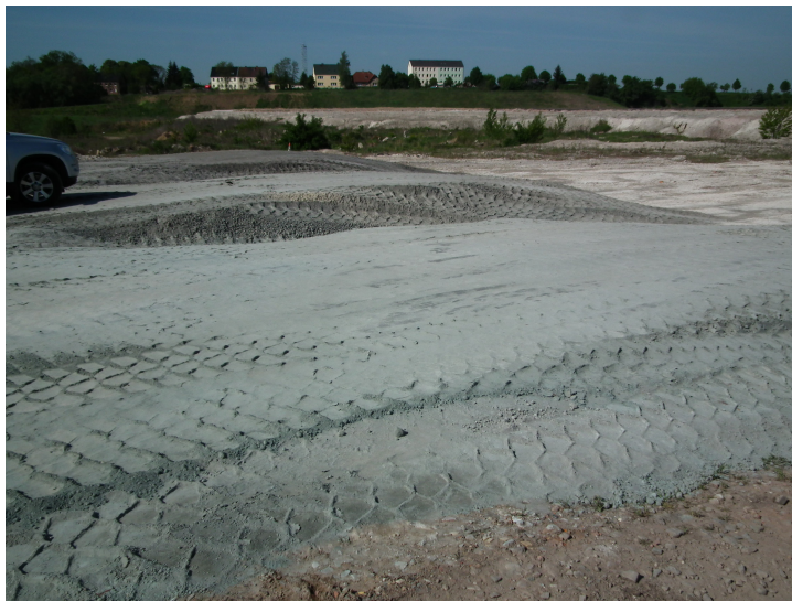
Abbildung 5-3: Probefelder Aschestabilisat mit Gießereialsand
