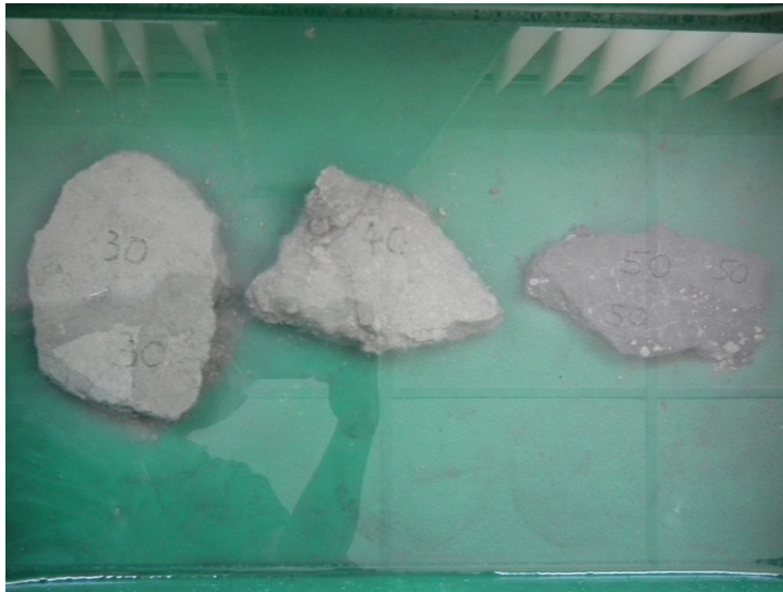
Abbildung 5-4: Bruchstücke aus den Probefeldern bei der Wasserlagerung
