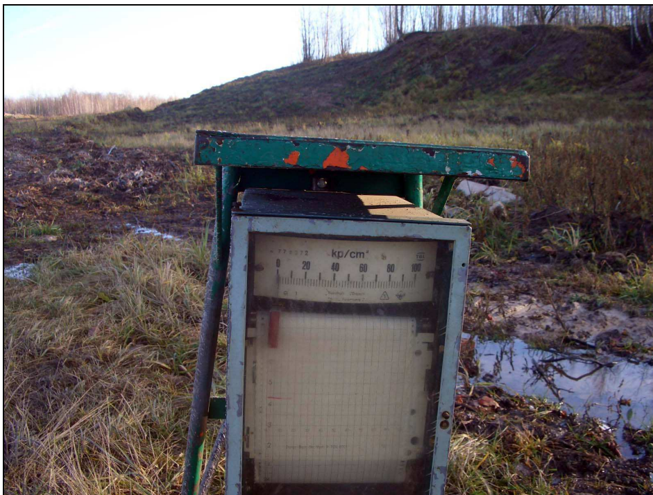
Bild 8: Druckaufzeichnung mit Druckbandschreiber
