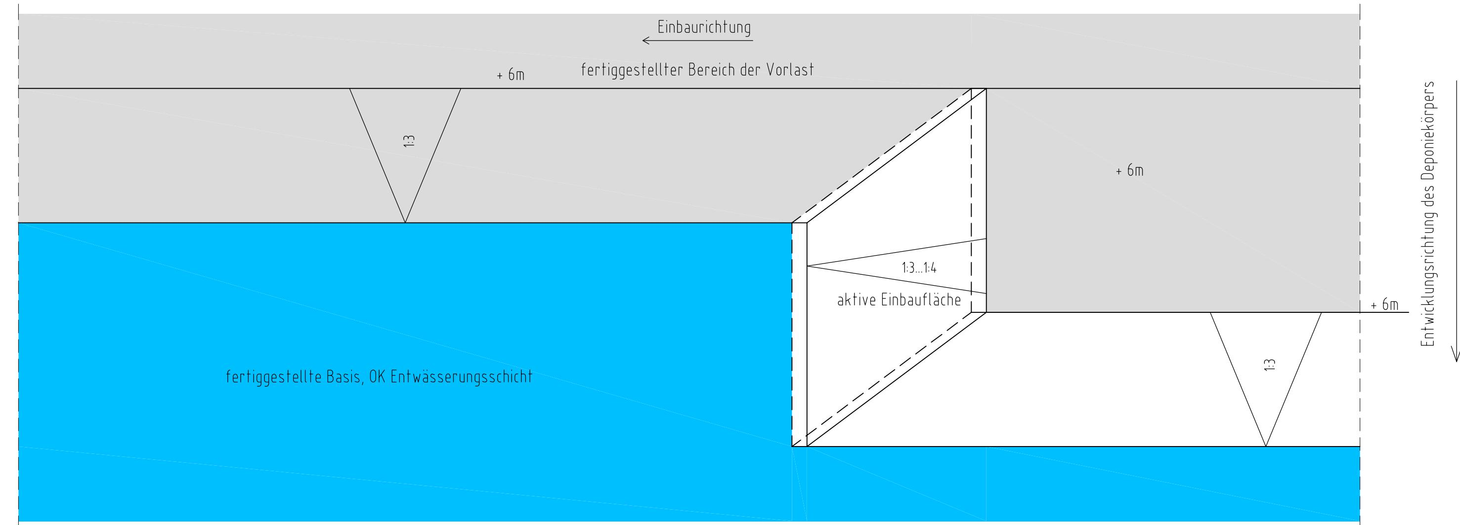
frühestens 3 Monate nach Fertigstellung der Vorlast (bis 6 m über OK Entwässerungsschicht) erfolgt die Fertigstellung bis 10 m Höhe analog
